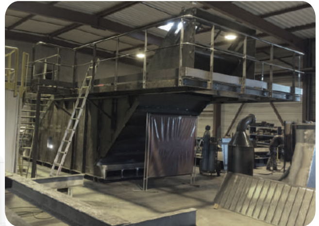
Fabrication dans nos ateliers d'un filtre à dépression
