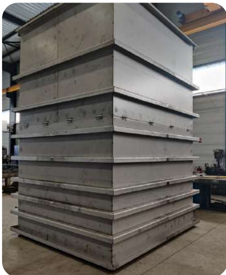
Fabrication d'une cuve Inox 316L
